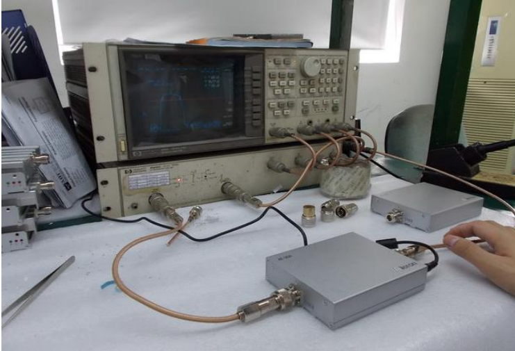
Фотографии испытаний АЕ-950 (используется аттенюатор 50 дБ). Uplink
