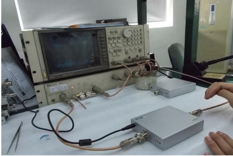
Фотографии испытаний АЕ-970 (используется аттенюатор 50 дБ). Downlink
